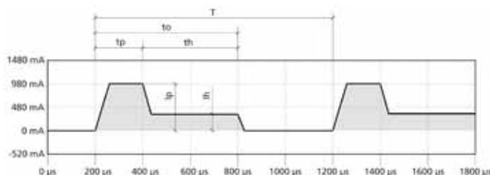
Dies ist eine beispielhafte Ansteuerung für kontinuierlich wiederholte Dosierung mit einer Frequenz von 1 kHz und einer Ventilöffnungszeit von 600  $\mu\text{s}$ . Strombild erzeugt mit der MVC-1 Steuerung. Spitzenstrom 1A, Haltestrom 200mA ( $t_h$  Haltezeit).
